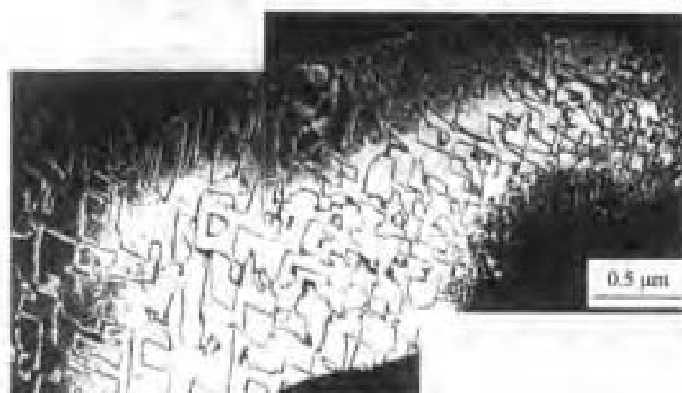
图 12-94 经 86% 轧制的无序 AuCu, 在 380 °C 退火 96 h 后 再结晶晶粒内出现的反相畴界
