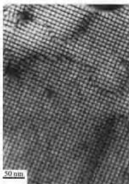
图 7-16 Si(001)扭转晶界的电子显微镜照片
