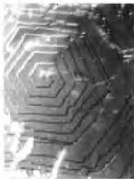
图 10-27 碘化锡晶体在其溶液中长大的表面螺旋 (干涉相衬显微照片, \times 1.025 )
