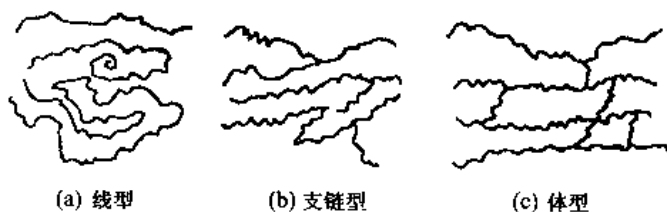
图 4-19 链的连接方式
