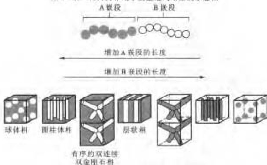
图4-42 二嵌段共聚物各种类型的有序结构
