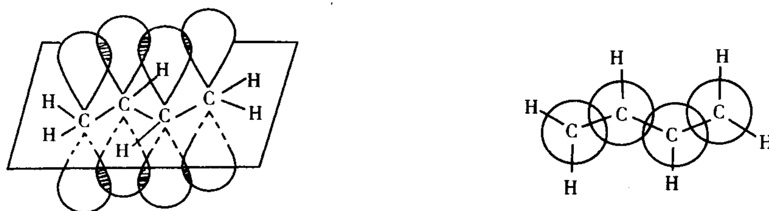
图 3-5 1, 3-丁二烯分子中 \pi 键的构成
