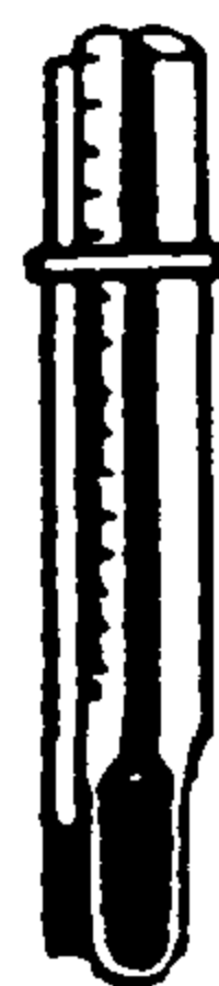
图 14-2 熔点管附在温度计上的位置
