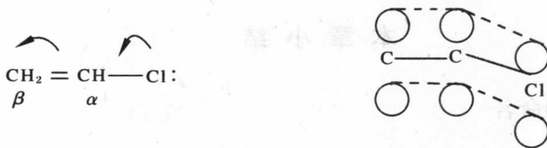
图 6-1 氯乙烯分子的 p-\pi 共轭示意图
