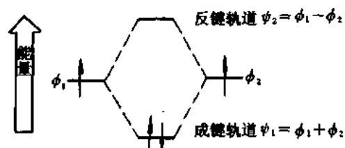
图 1-1 两个氢原子轨道组成 两个氢分子轨道
