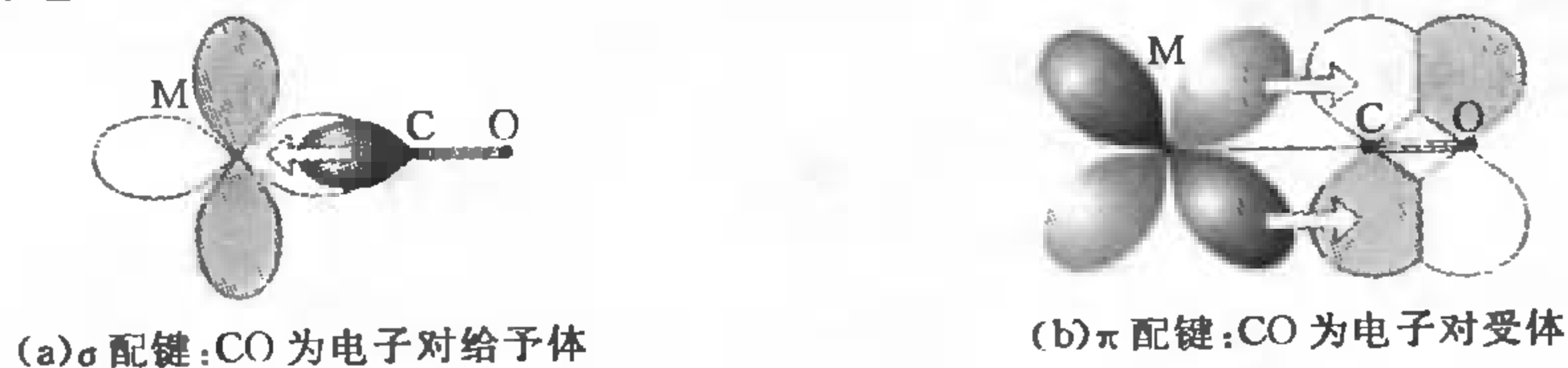
图 8-10 CO 与金属原子之间 \sigma 配键和 \pi 配键形成示意图
