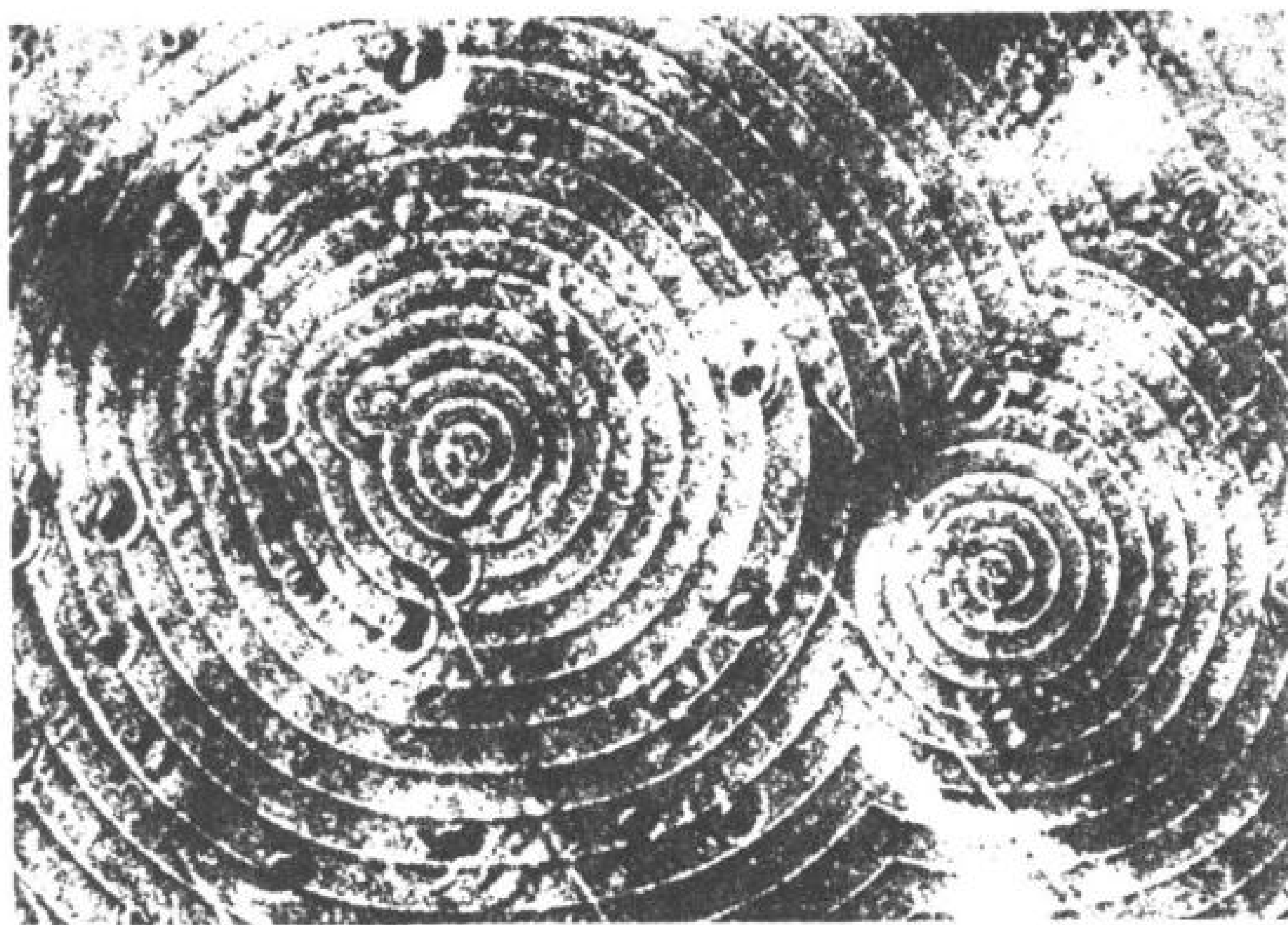
圖 7-9 金剛砂晶體中的螺旋錯位 (取自文獻 89)
