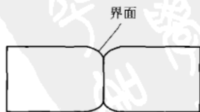
图 4.8 高温加热后 晶界出现的凹槽
