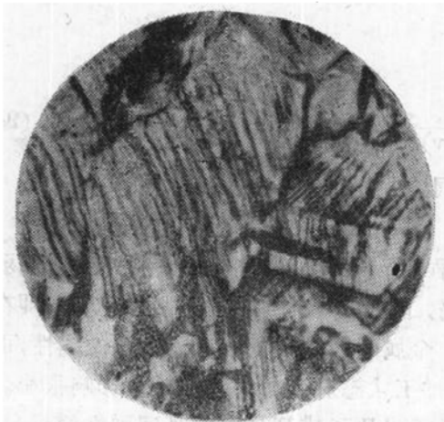
图 9-3 抛光金属(纯铜)试样中的滑移带 450 \times
