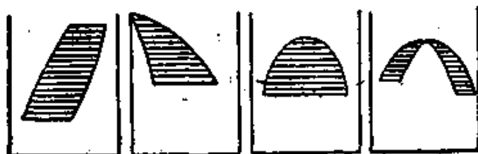
图 3.11 二元相图中的两相区.
