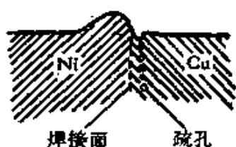
图 10.24 铜-镍对互扩散后横截面的变化。
