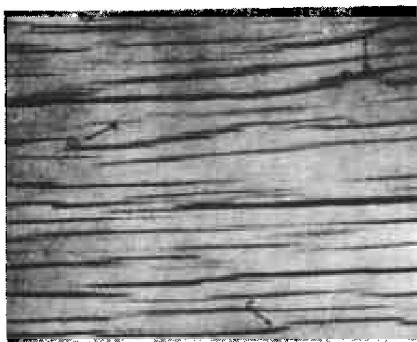
图 27.30 铜晶体第Ⅱ阶段碎裂的滑移带.
