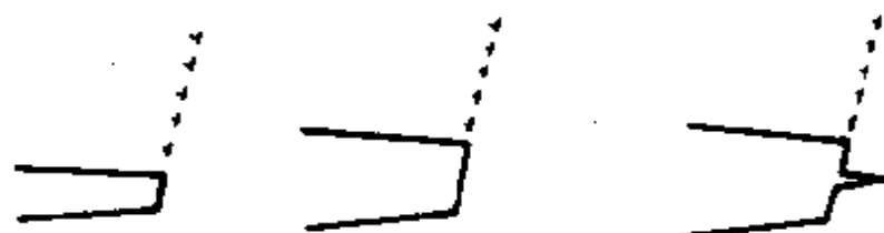
图 29.22 裂纹尖端发射位错造成裂尖钝化.
