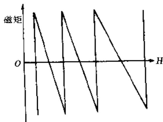
图 35.11 二维电子气磁矩随磁场的变化.
