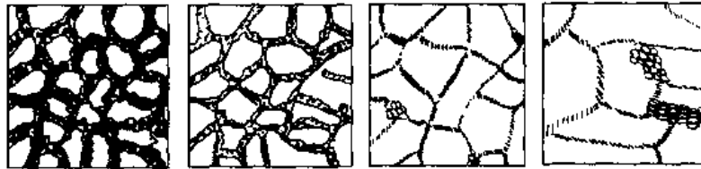
图 9-31 应变胞状亚组织在加热时的变化
