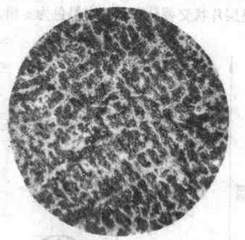
图 5-16 w(\text{Sn}) = 50\% 的 Pb-Sn 合金显微组织
