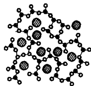
图 2-77 钠硅酸盐玻璃结构
