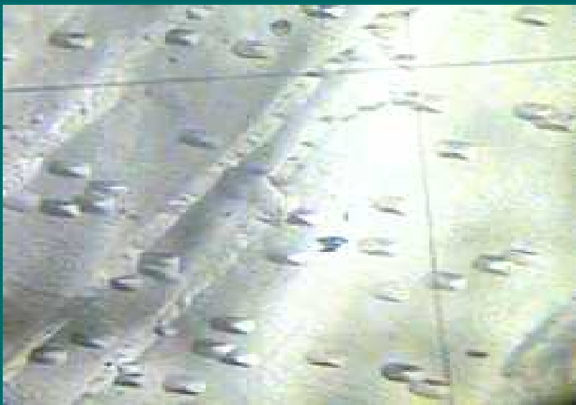
\text{GdVO}_4 (100) 面上的位错蚀像 12.5 \times 10
