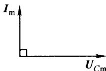
图 9.2-12 纯电容的电压、 电流的振幅矢量图
