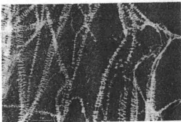
图 8-13 串晶及串晶结构模型 (高分子链连接着纤维束与晶片结构)
