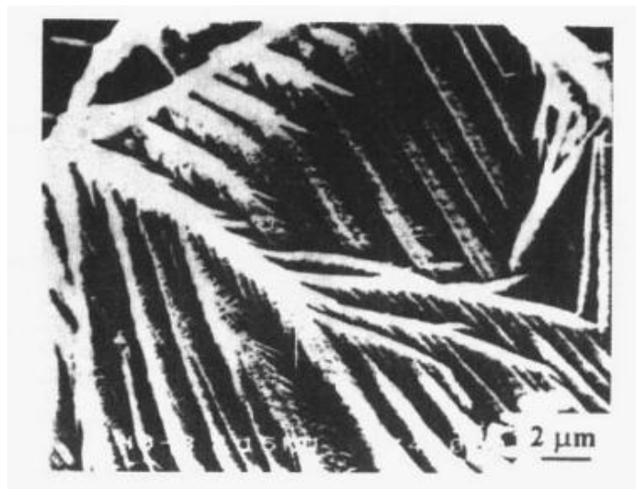
图 6-21 反应块表面的 Al-O 枝晶 [35]
