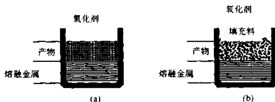
图 8-1 定向金属氧化过程示意图
