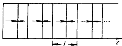
图 11-11 压电超晶格示意, 箭头表示极化方向
