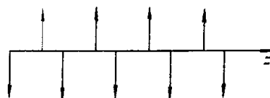
图 11-12 畴界处压电系数 不连续, 可看作 \delta 声源
