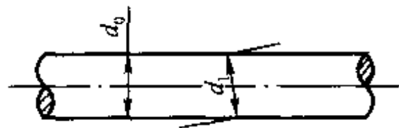
图 2-25 测量方法错误导致人为尺寸偏大的示意图
