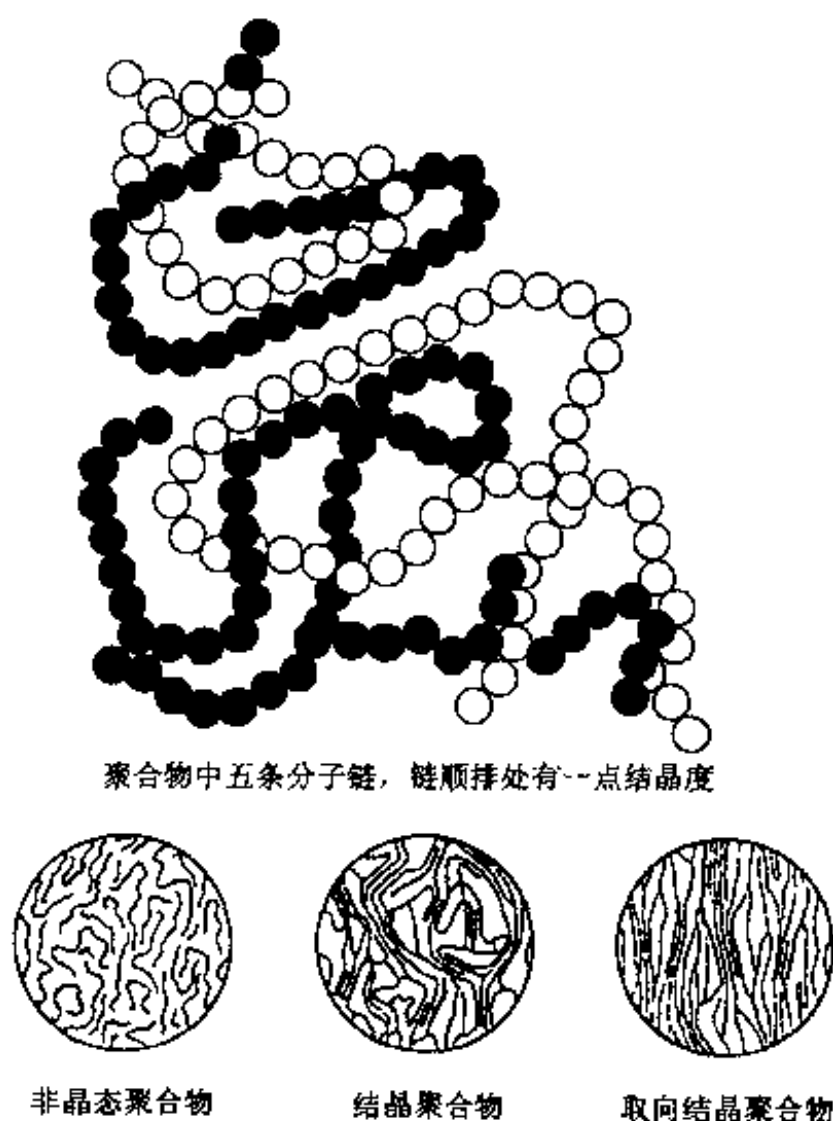
图 4.1.1 聚合物结构示意图
