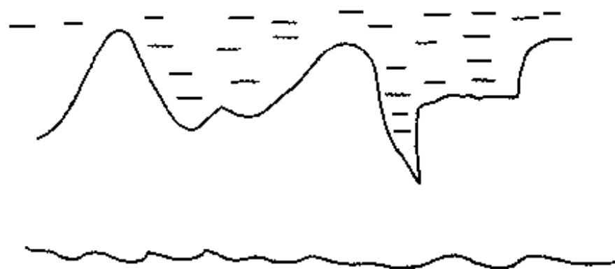
图 2.2.8 表面机械锁定力
