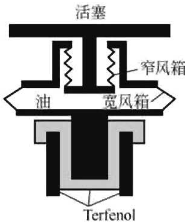
图 5-24 两级 Terfenol-D 动作器，液压行程放大器
