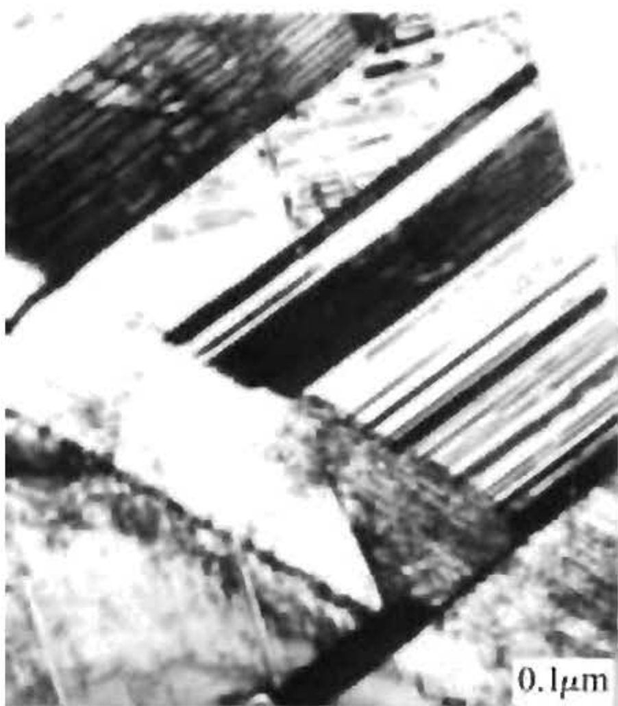
图 6-30 均匀化退火处理的 Co-28%Ni 合金的室温 透射电子显微像
