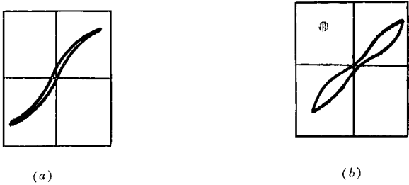
图 3 - 1 - 79 低损耗 MnZn 铁氧体的磁滞回线 ( a ) 等导型 ; ( b ) 叵明伐型
