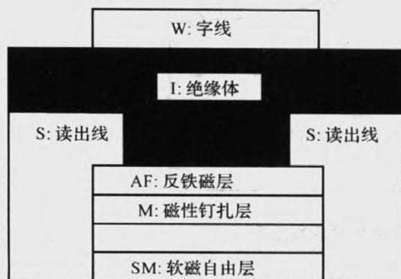
图 7.23 SV MRAM 结构原理
