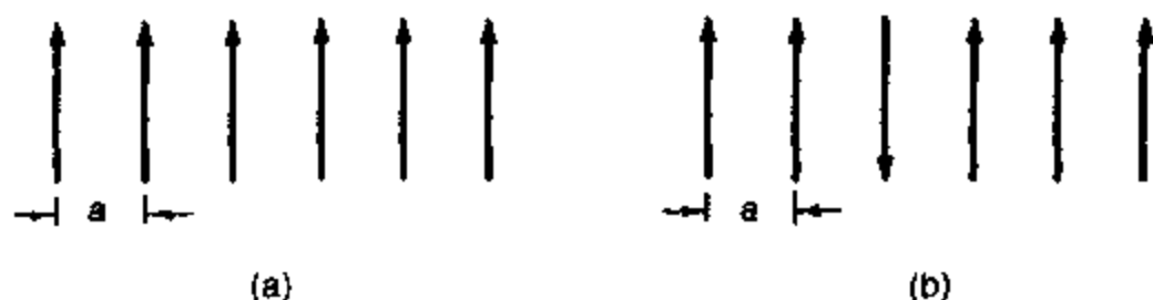
图 6.3 磁矩直线排列的两种可能组态。当 \alpha > 0 时平行取向是基态。
