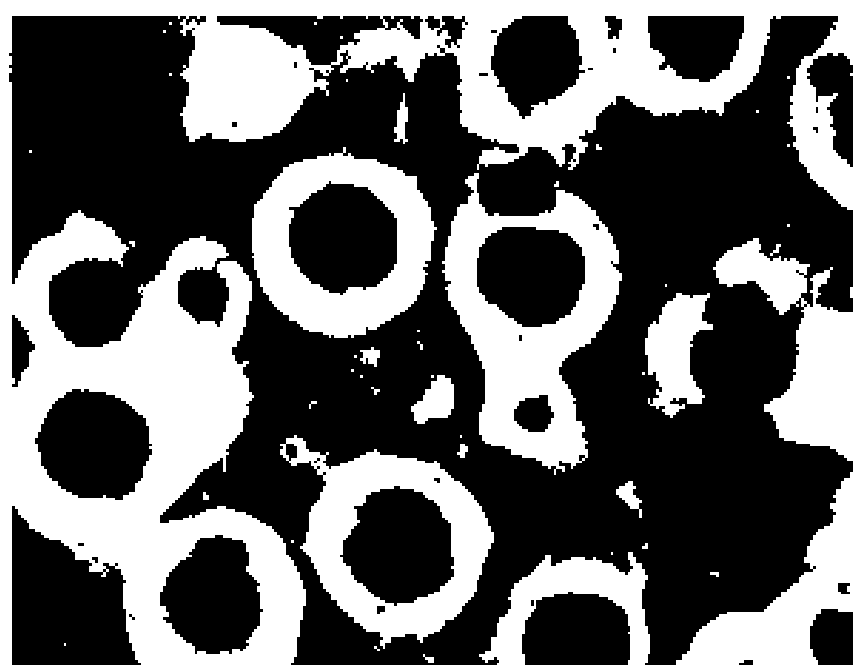
图 3-40 球墨铸铁的显微组织
