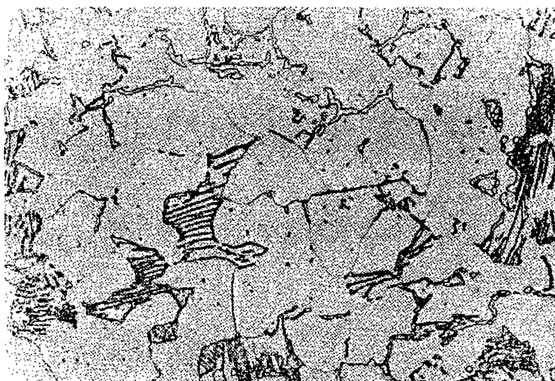
图 10-37 亚共析钢 (0.5% C) 的反常组织 (850℃ 10 分钟, 715℃, 500 秒, 水冷, ×500)
