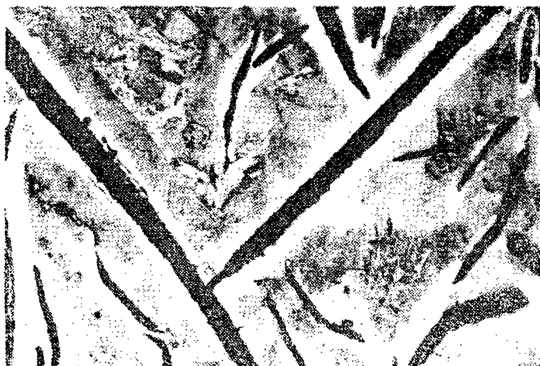
图 11-2 普通灰口铸铁显微组织（ \times 100 ）
