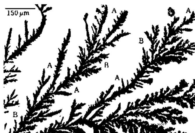
图 6.27 \text{FeSO}_4 电解沉积结晶形貌
