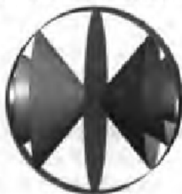
图 6-50 大量粉末的各种衍射,相应地形成各个衍射圆锥
