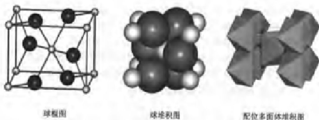
图 7-46 金红石( \text{TiO}_2 )晶体结构的三种图形表示
