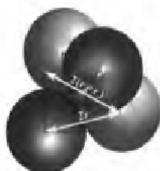
图 7-33 借助于正方体计算四配位的正-负离子半径比临界值
