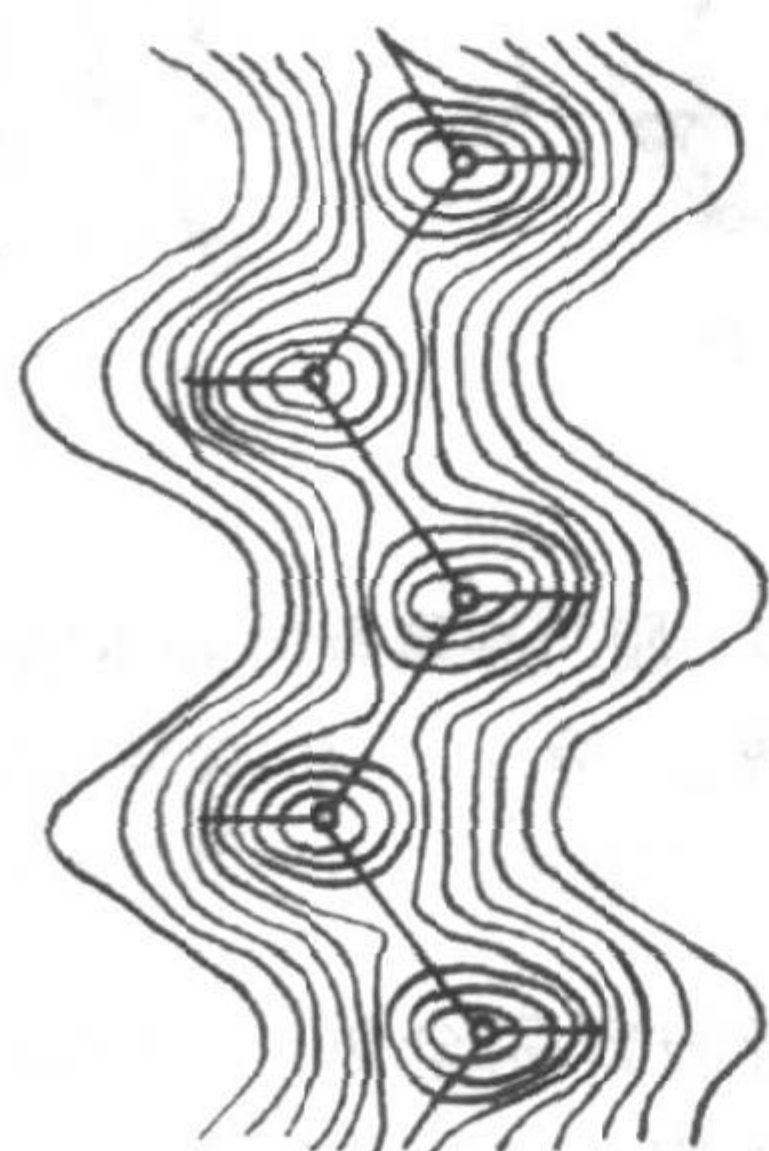
图 2-6 聚乙烯原子的电子云分布图
