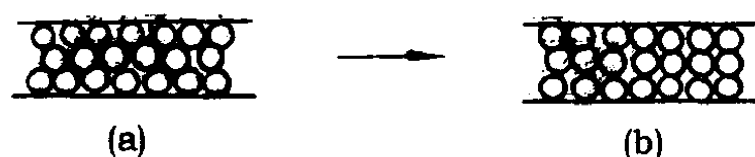
图 8-5 密集悬浮体在剪切作用下的膨胀 (a) 静止时的悬浮体 (b) 快速剪切下的悬浮体
