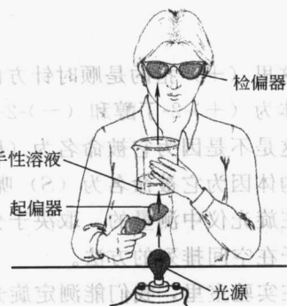
图 5-14 用灯泡和两副太阳镜做一个简单的旋光仪设备
