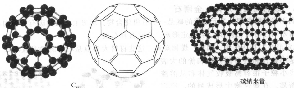
图 16-16 \text{C}_{60} 和碳纳米管的结构； \text{C}_{60} 中每个碳是一个五元环和六元环的桥头碳；一个纳米管是一个由类似于石墨的芳香六元环组成的圆桶；管子的尽头是半个 \text{C}_{60} 球；注意五元环如何使试管的末端结构弯曲
