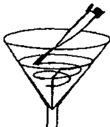
图 2-6 在滤纸上洗涤沉淀
