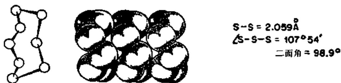
图 15-1 斜方硫的结构(环状的 S_8 分子的堆积层)
