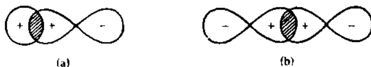
图 1.1 (a) 一个 s 轨道和一个 p 轨道重叠以及 (b) 两个 p 轨道重叠时形成 \sigma 键的示意图。
