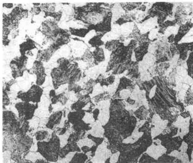
图 5-54 w_C = 0.4\% 碳钢的室温组织（铁素体和珠光体）
