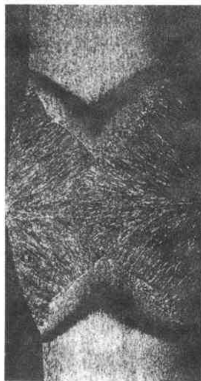
图 6-28 焊缝的宏观组织 4×
