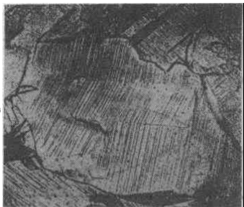
图 7-14 多晶体铜塑性形变后的表面
