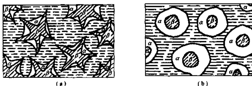
图 9-44 两种离异共晶的“牛眼组织” (a) 不完整的“牛眼组织”，(b) 完整的“牛眼组织”
