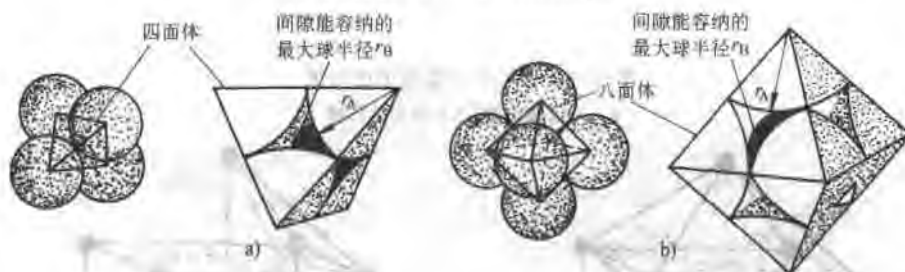
图 2-18 面心立方结构中间隙的刚球模型
