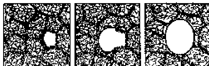
图 10-11 亚晶界迁移,亚晶长大形核模型
