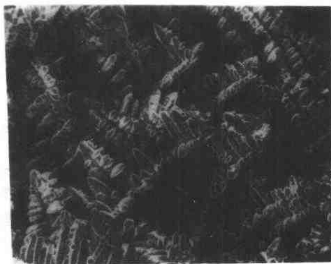
图 5.11 低碳钢锭中心缩孔处的枝晶组织(7×)
