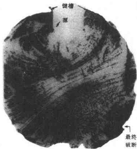
图 8.24 一个带键槽的 40 钢轴的疲劳断口 (硬度为 HRC30)
