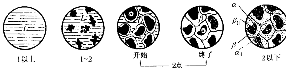
图 4-14 合金 III 的平衡凝固过程
