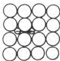
图 2.19 间隙扩散示意图
