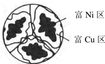
图 5.6 Cu-Ni 合金枝晶偏析示意图
