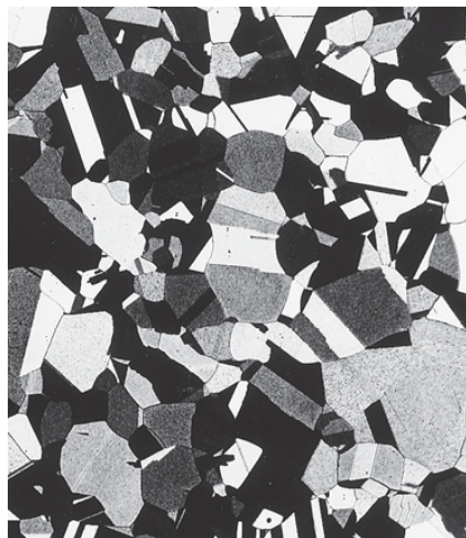
580°C再结晶完成后保温15min
