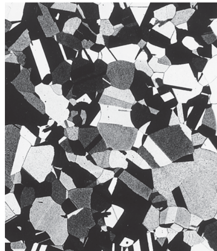
580℃再结晶完成后保温15min
