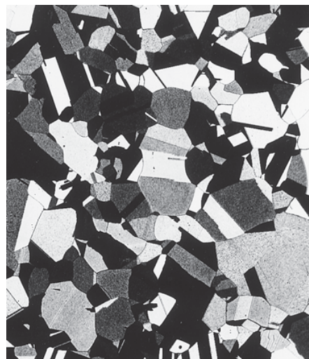
580°C再结晶完成后保温15min
