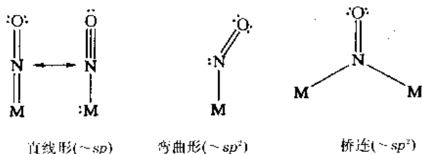
图 11.10 直线形、弯曲形和成桥NO配合物的键合示意图。
