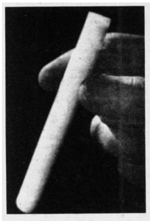
图 A \beta -氧化铝陶制电解质管 (摘自电学协会研究中心, 公共运输用钠-硫电池)
