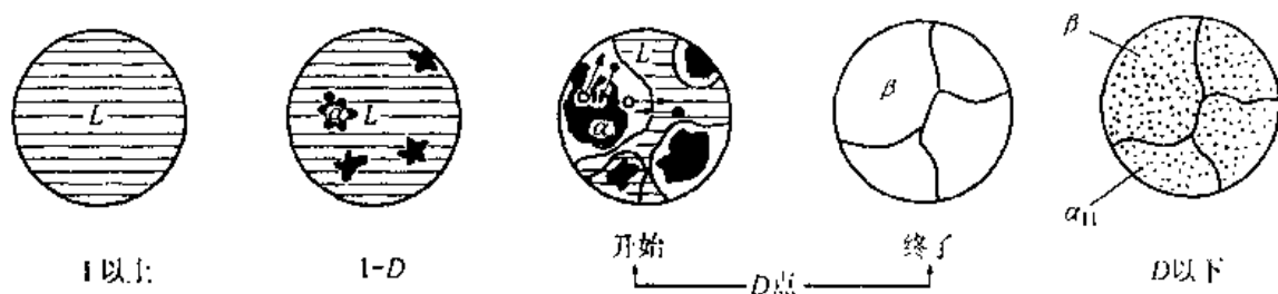
图 4-28 合金 I 的平衡凝固示意图
