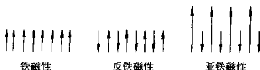
图 4-75 铁磁性、反铁磁性、亚铁磁性的自旋排列
