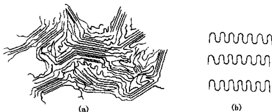
图 3-12 聚合物的晶态结构模型
