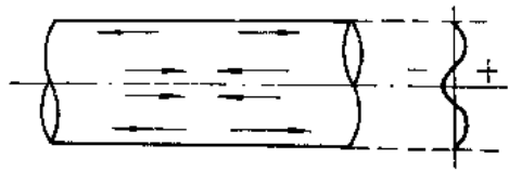
图 7-46 金属拉丝后的残留应力
