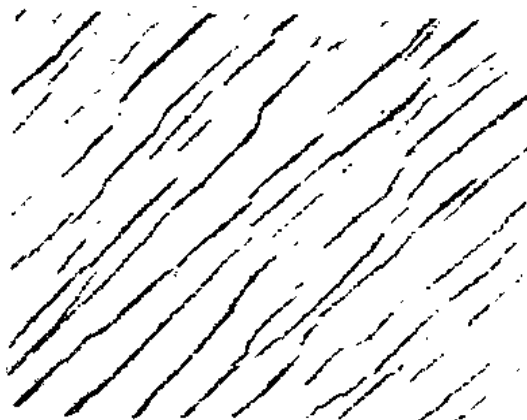
图 7-14 波纹状滑移线
