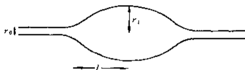
图 10-12 位错上的核心形状的示意图
