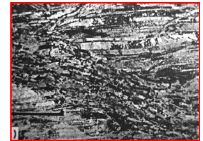
65%压下量形变孪晶及切变带，TEM照片
