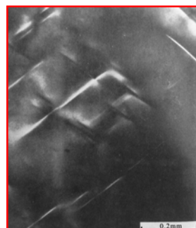
聚乙烯中出现的剪切带
