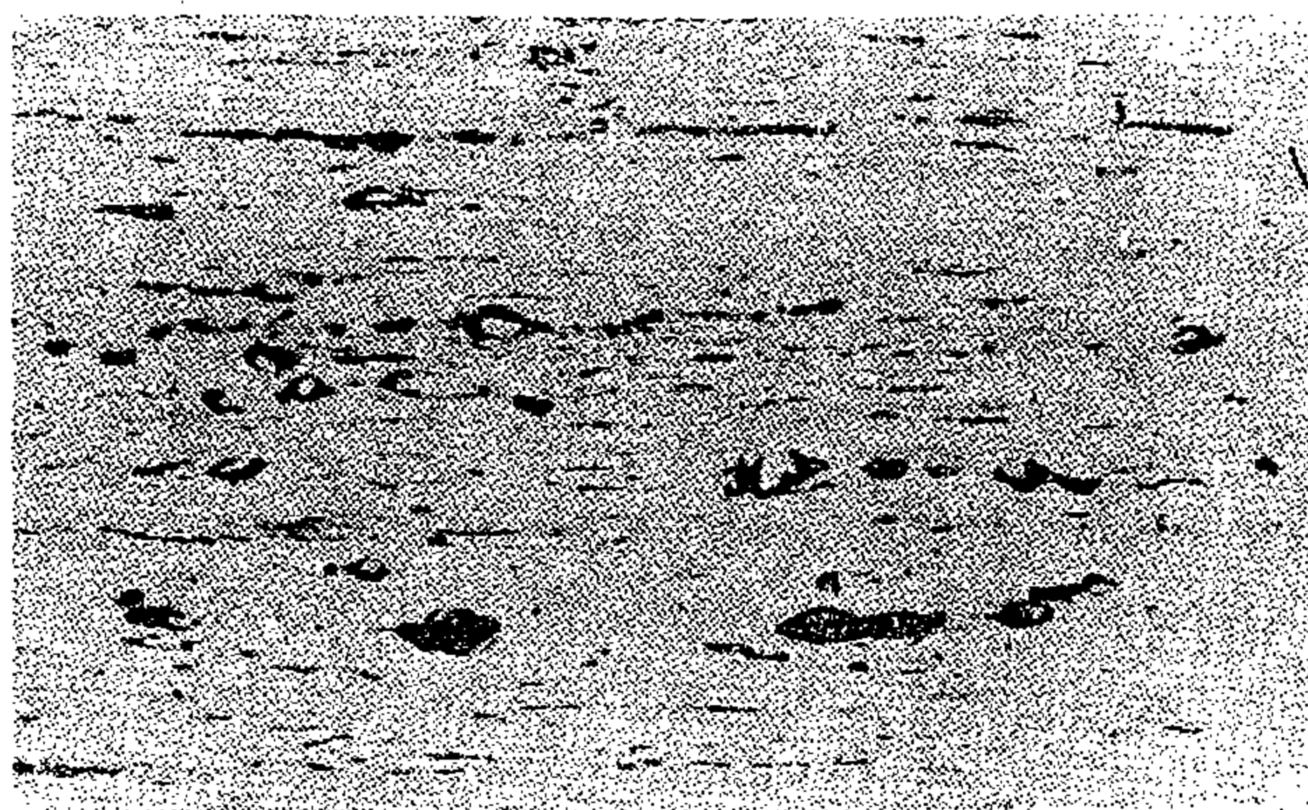
图 10-45 冷形变钢（变形 98%）中的显微空洞（ \times 1000 ）
