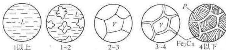
图 4.13 w_C 1.2\% 碳钢的结晶过程示意图
