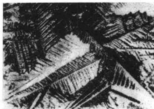
图 2.28 纯铈锭表面的树枝晶
