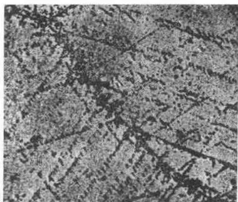
图 8.18 w_{Cr}25\%-w_{Ni}20\% 不锈钢内碳化物在晶界和滑移线的局部脱溶
