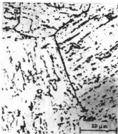
图 8.9 淬火低碳钢 ( w_c 0.18\% ) \alpha 相的回复组织 ( 600^{\circ}\text{C} 回火 10 min)
