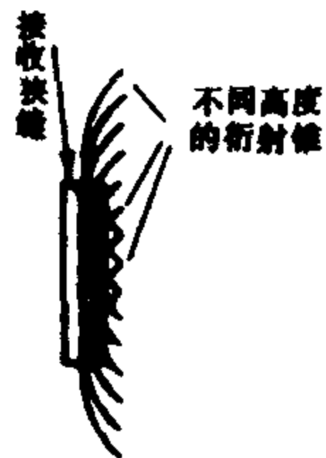
图11-6 垂直发散误差示意图。由于有不同高度的衍射线,因而造成衍射线重心向锥内方向偏移,图中画的是接收狭缝应有的 2\theta 位置,实际要向右移才能测得最大强度
